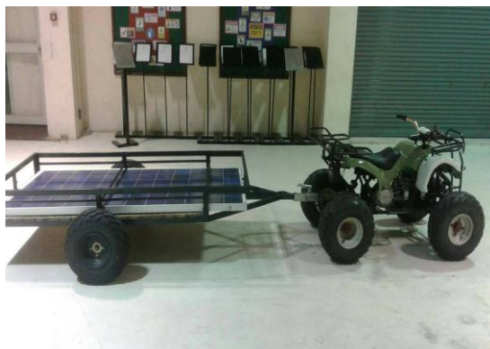
รูปที่ 5 แสดงภาพรถยนต์ไฟฟ้าอเนกประสงค์พร้อมติดตั้งแผงโซล่าเซลล์
