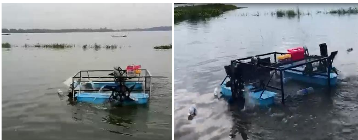
รูปที่ 6 ภาพทดลองเก็บขยะด้วยเรือเก็บขยะบังคับวิทยุ
