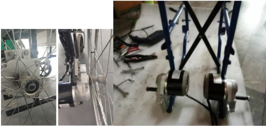
รูปที่ ๔ การติดตั้งระบบขับเคลื่อนเข้ากับวงล้อของรถเข็นผู้ป่วย
